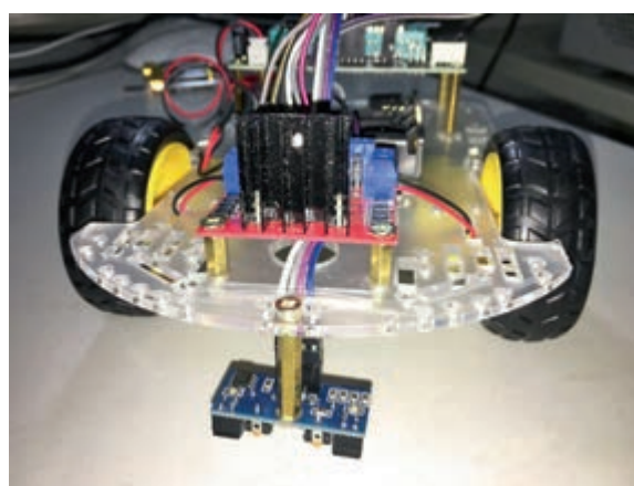
图 1-59 安装红外循迹模块并连线
