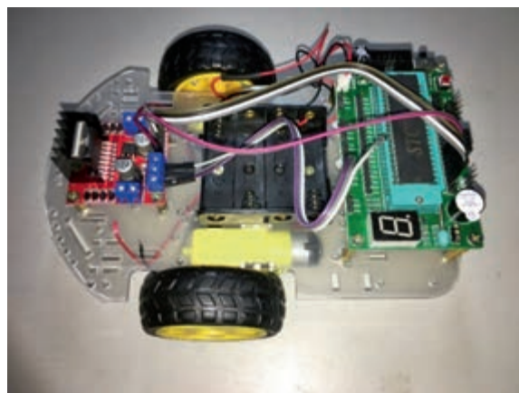
图 1-58 安装电池盒组件并连线
