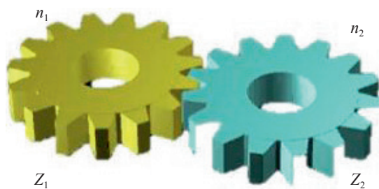
图1-44 齿轮传动比的计算
