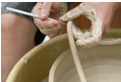
5. 修整规整后，用割线将坯体割下，轻放在阴凉处。
