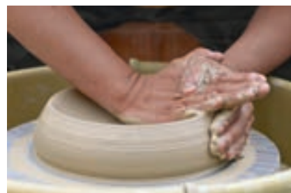
3. 蘸水使泥湿润，匀速转动拉坯机，练泥把正后，双手配合，用掌根按压中心，将开孔扩大。
