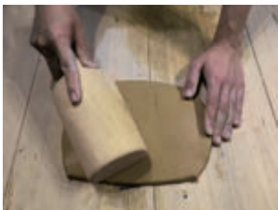
2. 拍一厘米左右厚度的泥片，用作器皿底部。
