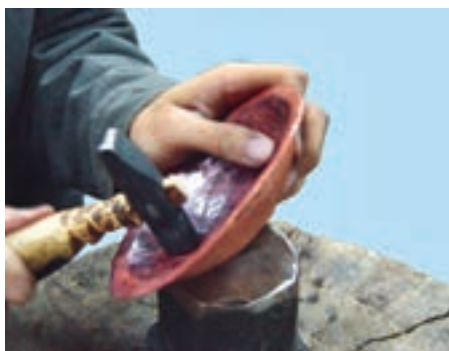
1. 在大铁砧上敲打以增加高度。
