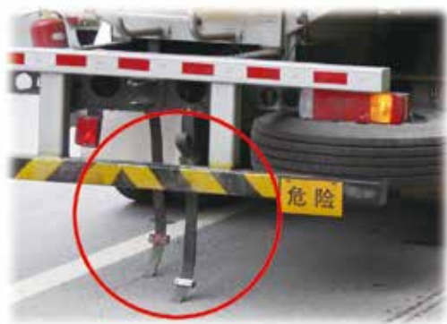
图1-35 油罐车车尾装有导电拖地带
