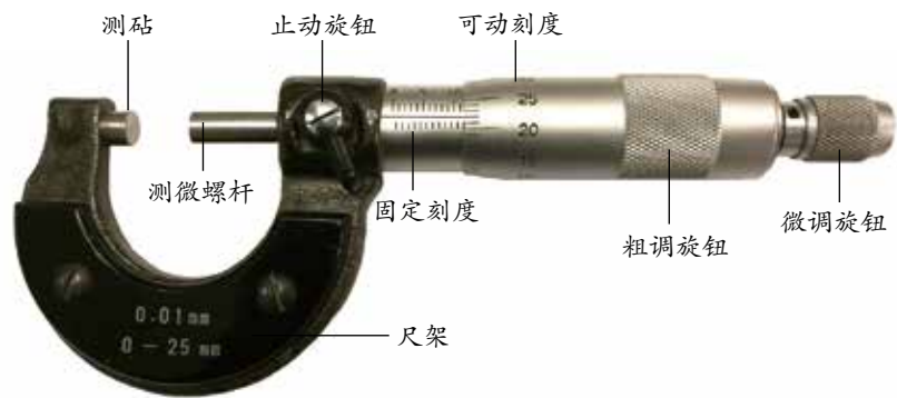
图 3-35 螺旋测微器的结构
