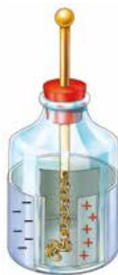
图 2-22 莱顿瓶结构示意图
