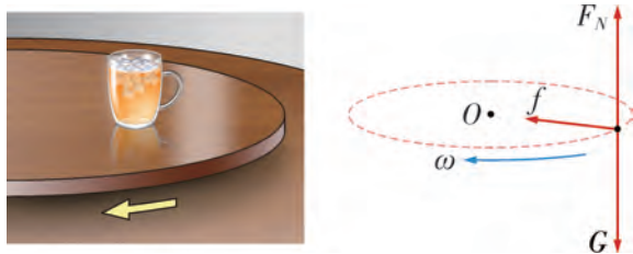
图 2-2-2 旋转圆桌上的杯子及其受力分析
