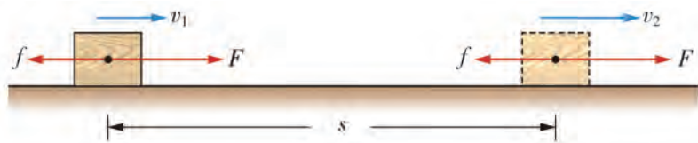
图4-3-3 物体在恒定拉力 F 的作用下沿水平面运动
