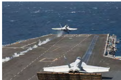
图 4-3-4 战斗机利用弹射器起飞
