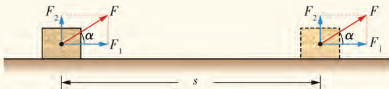
图4-1-3 力的方向与物体位移的方向之间存在夹角的情况
