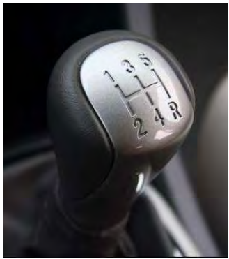
图 4-2-4 手动挡汽车上的变速杆
