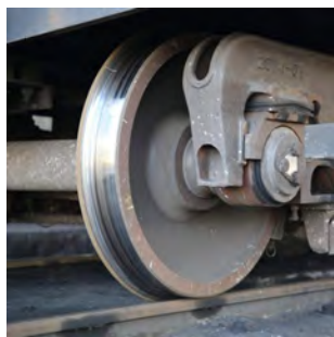
图 2-3-5 火车车轮的轮缘受铁轨挤压
