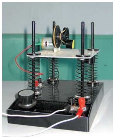
图 2-5-9 模拟机器共振
