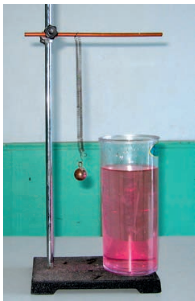
图 2-5-2 研究弹簧振子能量的损失
