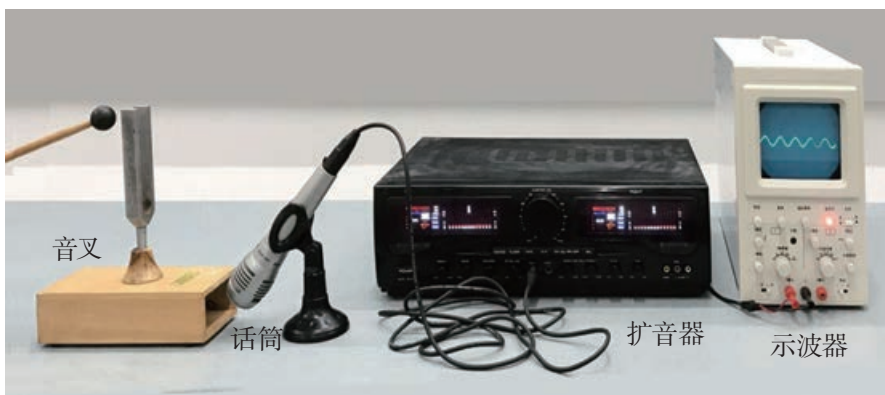
图 2-1-5 用示波器研究声振动
