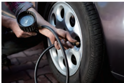
图 11-5 指针式压强计测轮胎气压
