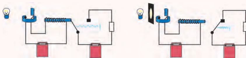
图 14-7 开关控制电路
