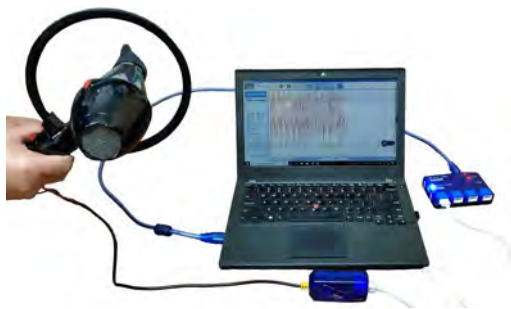
图 11-36 用微电流传感器检测电磁波
