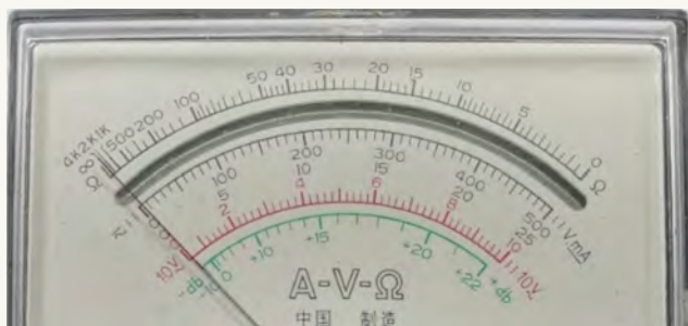
图 10-35 指针式多用电表的刻度盘
