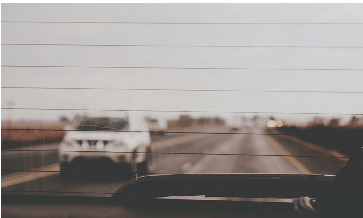
图 10-20 汽车后挡风玻璃上的电阻丝
