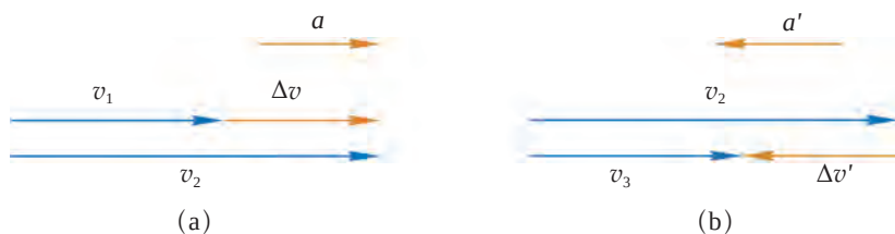
图 1-31 加速度方向与速度方向的关系
