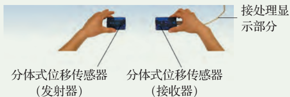
图 1-11 用传感器测量位移的大小
