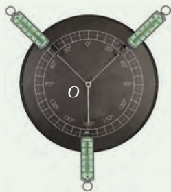
图 3-44 用三个弹簧测力计验证三个共点力平衡的条件
