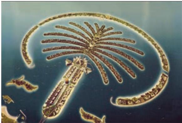
人工岛：朱美拉棕榈岛是阿联酋迪拜棕榈岛工程所建的第一个人工岛，目的是解决自然沙滩被开发殆尽的问题。该岛始建于2001年，由一个棕榈树干形状的主岛、17个棕榈叶形状的半岛和顶部新月形防波堤三部分组成。棕榈树的形状能最大限度地扩展沙滩面积。
