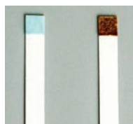
图 7.34 滴加蒸馏水（左）和 2% 葡萄糖溶液（右）的检测试纸
