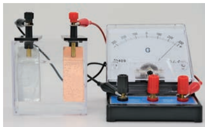
图 5.22 原电池实验装置
