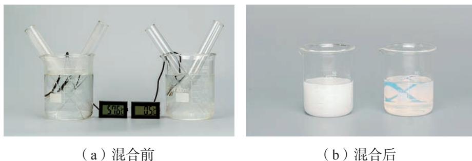
图 6.4 不同温度下硫代硫酸钠与盐酸的反应
