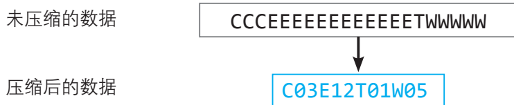
图1.2.10 简单的无损压缩编码示意图
