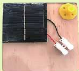
1. 安装太阳能灯底板、电池板、接线器。
