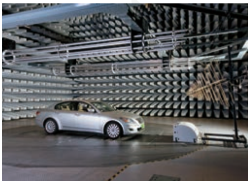
图3-111 整车在电波暗室进行抗扰度测试
