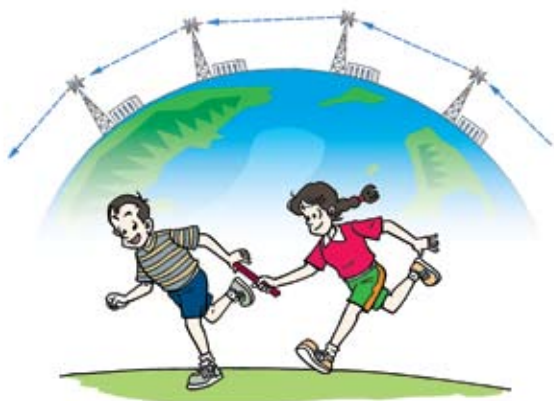
图17-4-1 微波中继通信示意图
