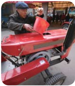
图19-4-4 工作的发动机用水冷却
