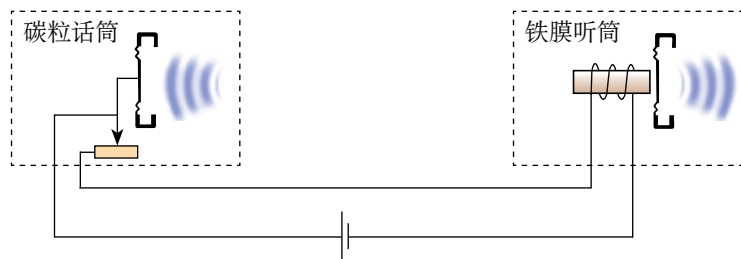
图17-1-10 老式电话机的原理图
