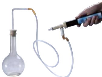
图19-3-8 空气推动瓶塞时,内能减少
