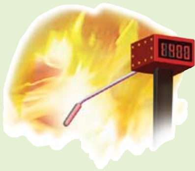
图18-1-8 热电偶温度计
