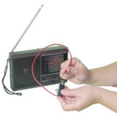
图17-2-1 时断时续的电流能够产生电磁波
