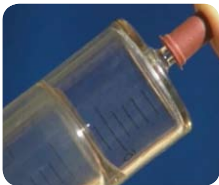
图18-3-7 压缩乙醚使其液化
