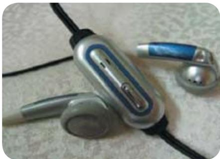
图12-4-4 MP3耳机音量调节用的电位器
