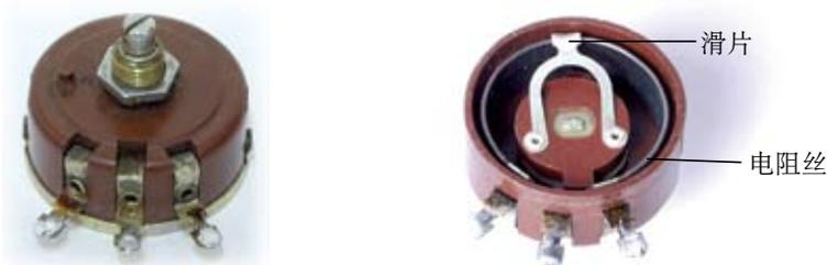
图12-4-3 电视机音量调节用的一种电位器及其内部构造
