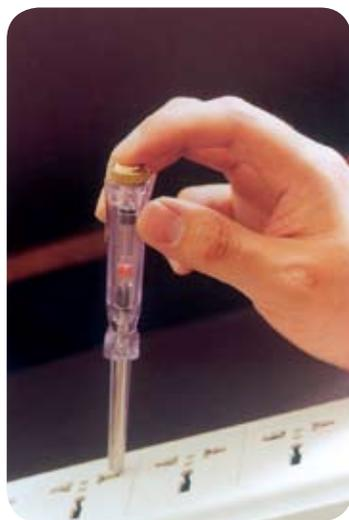
图15-1-3 火线能使试电笔氖管发光
