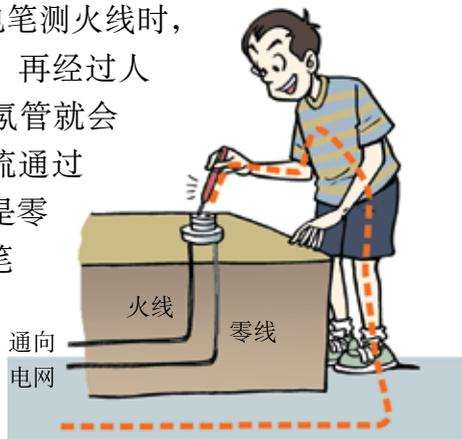
图15-1-4 用试电笔测火线
