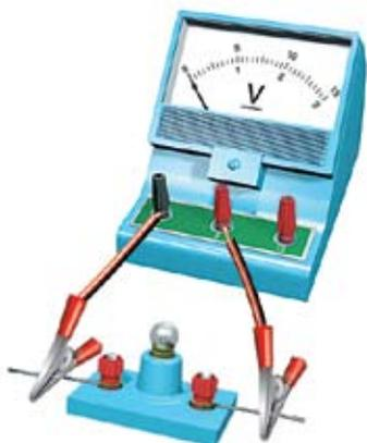
图12-1-8 用电压表测小灯泡两端的电压
