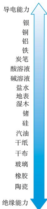
图12-3-2 常温下部分物体的导电和绝缘能力的排列顺序
