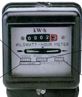
“10 (20) A”表示这个电能表的标定电流为10 A，额定最大电流为20 A，电能表工作时的电流不应超过额定最大电流
