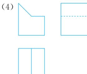
**例 5** 某工厂要加工一批密封罐，设计者给出了密封罐的三视图（图 35.2-12）。请按照三视图确定制作每个密封罐所需钢板的面积（图中尺寸单位：mm）。
